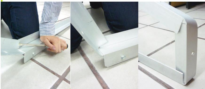
6. Con todos los lados doblados deben juntarse los extremos y encajar bien para poder perforarlos y fijarlos correctamente.
