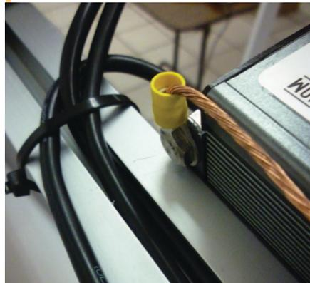
4. Doble y suelde otra entrada donde colocara el otro tornillo, Asegúrate que el cable quede tenso entre los tornillos.
