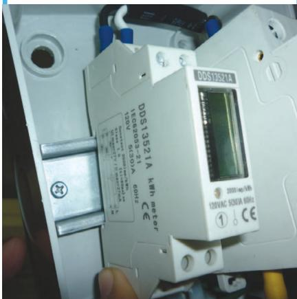
36. Con un desarmador plano empuja la pestaña que sobre sale del medidor. Hasta que escuches un clic
