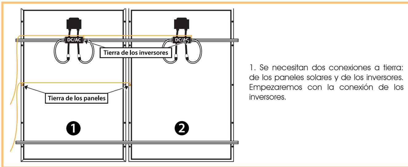
1. Se necesitan dos conexiones a tierra: de los paneles solares y de los inversores. Empezaremos con la conexión de los inversores.
